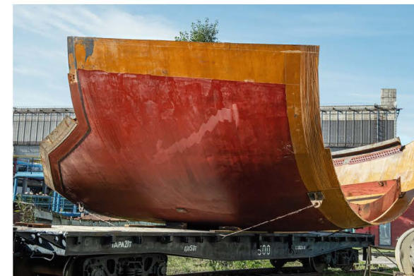
Так выглядит готовое изделие из композитного материала – обтекатель гидроакустического комплекса
